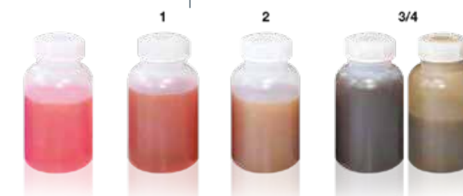
Slika 4: Prikaz promjena boje rashladne tekućine po fazama onečišćenja
